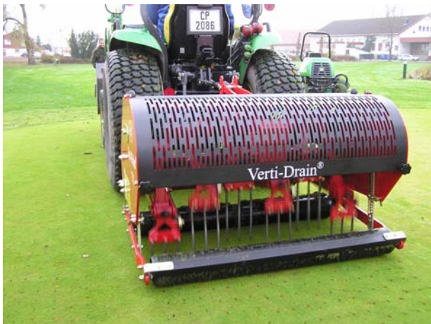
Eksempel på mekanisk lufter. Foto: Agnar Kvalbein
